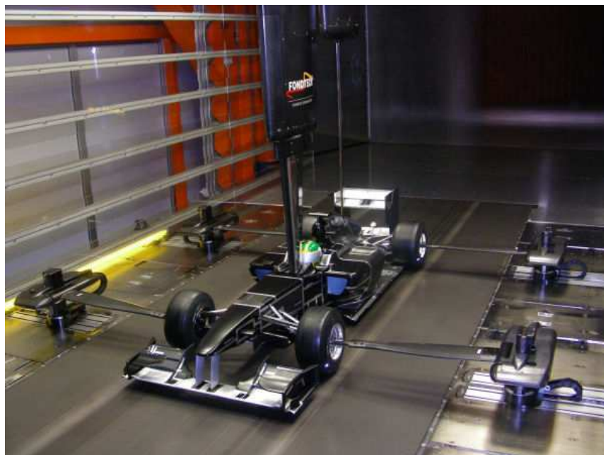
F1 2010 wind tunnel model
